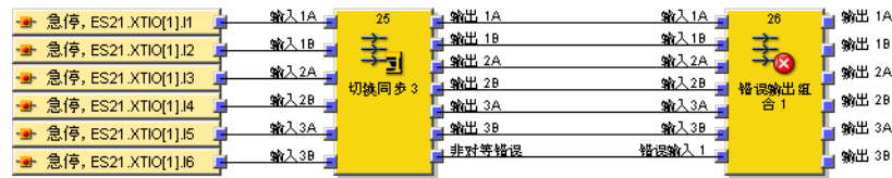
插图 112: 错误输出组合功能块的逻辑示例
