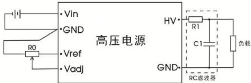
图 3-1 减小纹波噪声滤波电路
