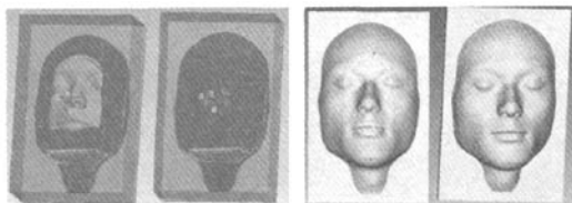
图3 pro/NC精加工刀具轨迹线框图和 VERICUT 刀具轨迹动态图形仿真
